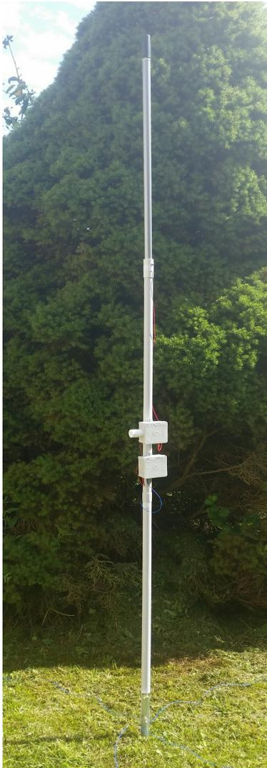
**Antenne ist in 3 x 0,8 m langen Elementen zerlegbar ( 2 x Installationsrohr und 1 x Besenstiel ) .**
