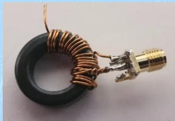
Die Mantelwellensperre verhindert **reziproke** Ströme im Gebäude ohne die Anpassung und die Antennenfunktion zu verschlechtern
